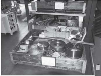
左：プレス機械の主要部品。 右：完成間近のリビルド機
