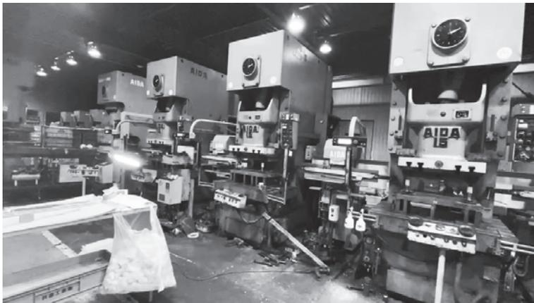
写真6 2軸サーボ駆動ロボットライン
