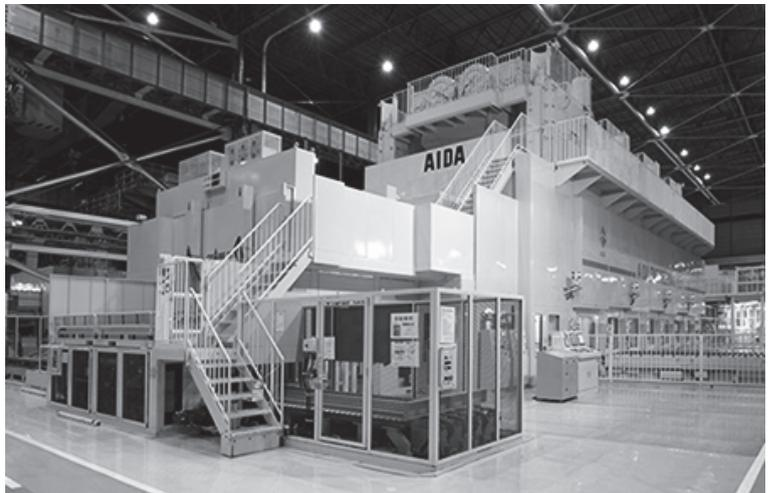
写真 5 大型サーボプレスによるタンデムライン
