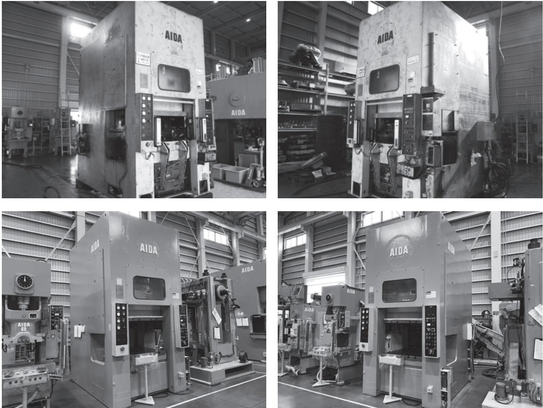
写真 10 リビルトして復活したプレス機械（上段がリビルト前、下段がリビルト後）
