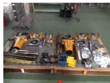
スライド解体整備
