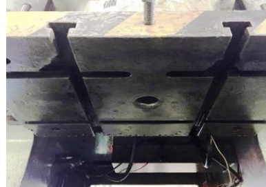
T溝補修・面引き
