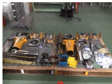
スライド解体整備
